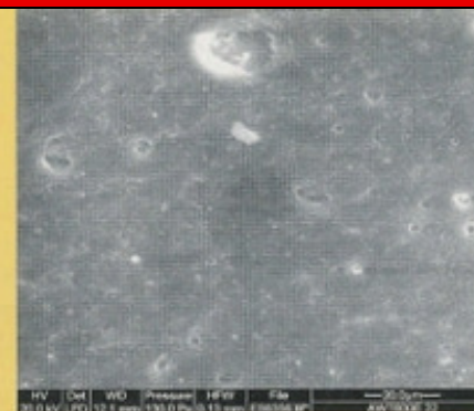
Abb. 18: THF-behandelt (20 µm Maßstab)
