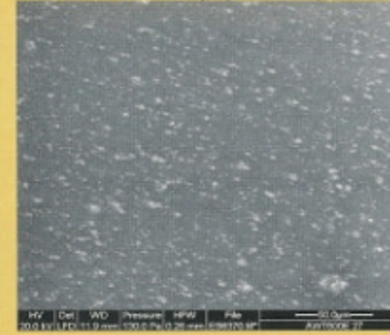
Abb. 25: PVC-Reiniger, nichtanlösend (50 µm Maßstab)
