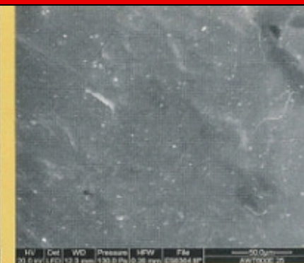
Abb. 19: THF-behandelt (50 µm Maßstab)
