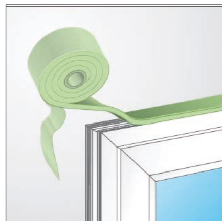
Obr. 2: Komplet. utěs. v jednom prac. kroku
